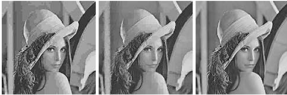
Abb. 3.5-6: Vergleich der Codierqualität bei 0.18 bpp an Hand der Bildvorlage Lena : JPEG (links), Fraktal (mitte), Wavelet (rechts, JPEG 2000 kompatibel)
