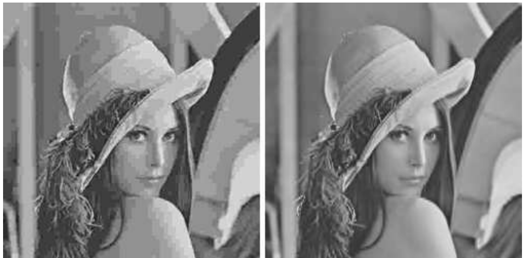
Abb. 3.4-9: Codierungsergebnis für Testbild Lena bei 0.18 Bit/Pixel: Klassisches JPEG (links), JPEG 2000 (rechts)
