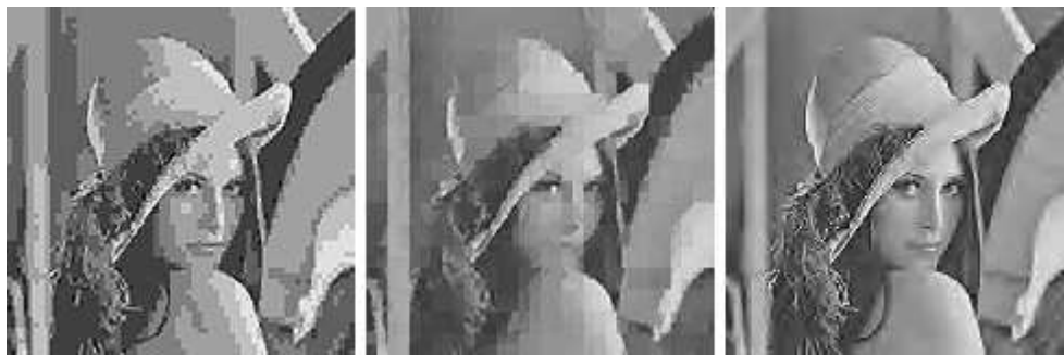
Abb. 3.5-7: Vergleich der Codierqualität bei 0.07 bpp an Hand der Bildvorlage Lena : JPEG (links), Fraktal (mitte), Wavelet (rechts, JPEG 2000 kompatibel)
