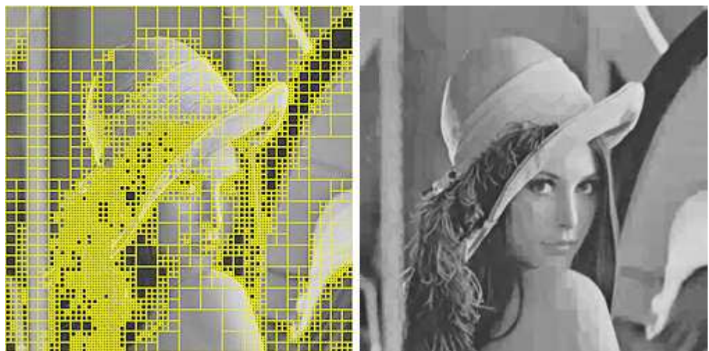
Abb. 3.5-4: Quadtree-Zerlegung (links) und Codierungsergebnis (rechts) bei der Bildvorlage Lena (ca. 0.42 Bit pro Pixel)
