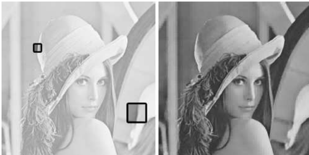
Abb. 3.5-3: Links: Beispiel für eine Selbstähnlichkeit in der Bildvorlage Lena : Range-Block links (klein); zugehöriger Domain-Block rechts (groß) Rechts: Codiererergebnis - IFS (ca. 0.52 Bit pro Pixel)
