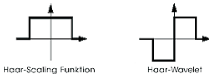
Abb. 3.4-5: Haar-Scaling Funktion und alternatives Haar-Wavelet.
