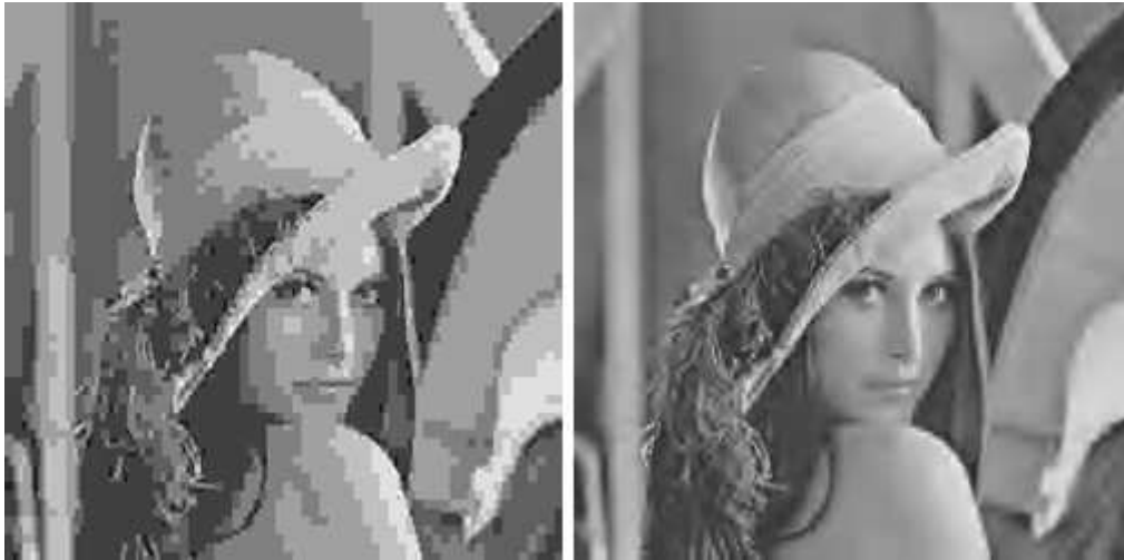
Abb. 3.4-10: Codierergebnis für Testbild Lena bei 0.07 Bit/Pixel: Klassisches JPEG (links), JPEG 2000 (rechts)
