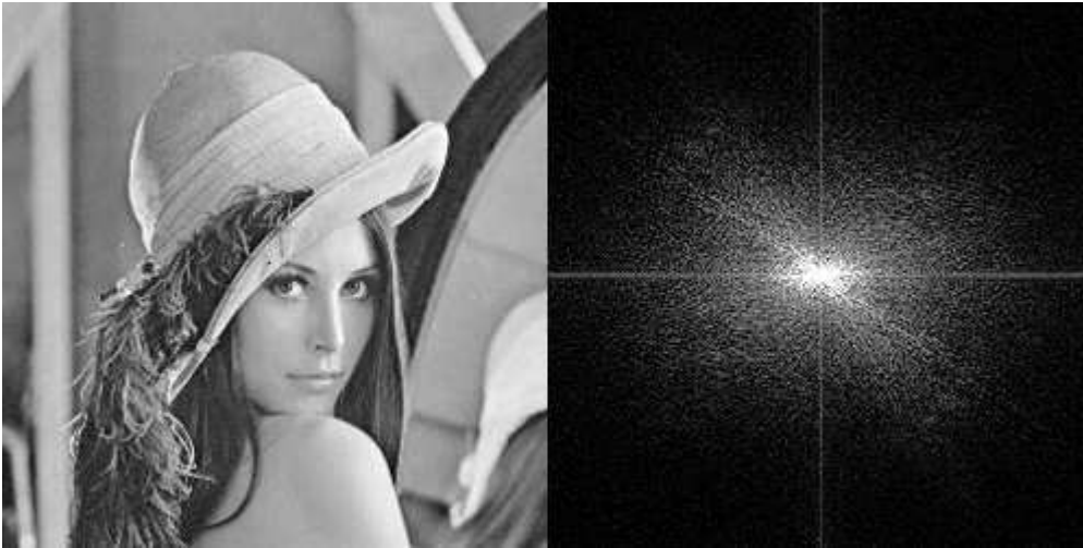
Abb. 3.1-2: Testbildvorlage Lena (links) und Abbild nach der Fast Fourier Transformation (rechts)
